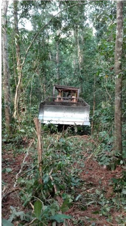
Abbildung 1: Débusquage avec « pelle haute » / Forwarding with raised front shield / Rücken mit angehobenem Frontschild
